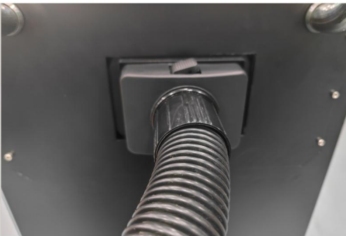
3.将吸尘口和吸油桶连接
