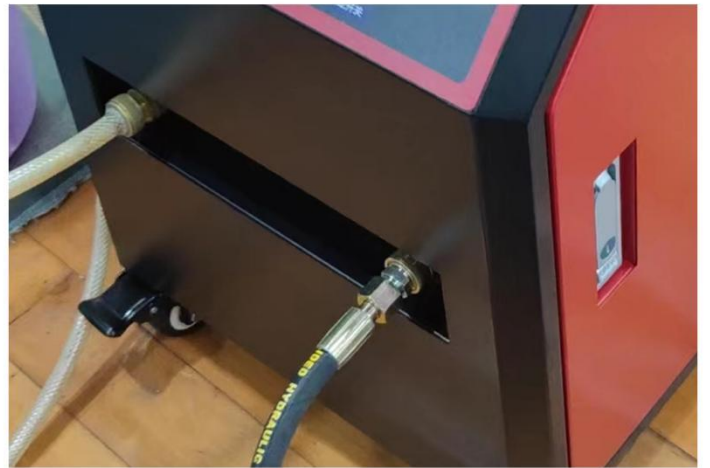
2.将高压清洗进水管与高压清洗进水口连接，将进水管完全放入水中。高压清洗出水管(黑色)与高压清洗出水口连接。
