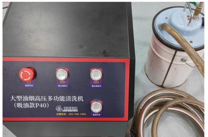
4.将吸尘吸油口与吸油桶平口连接
